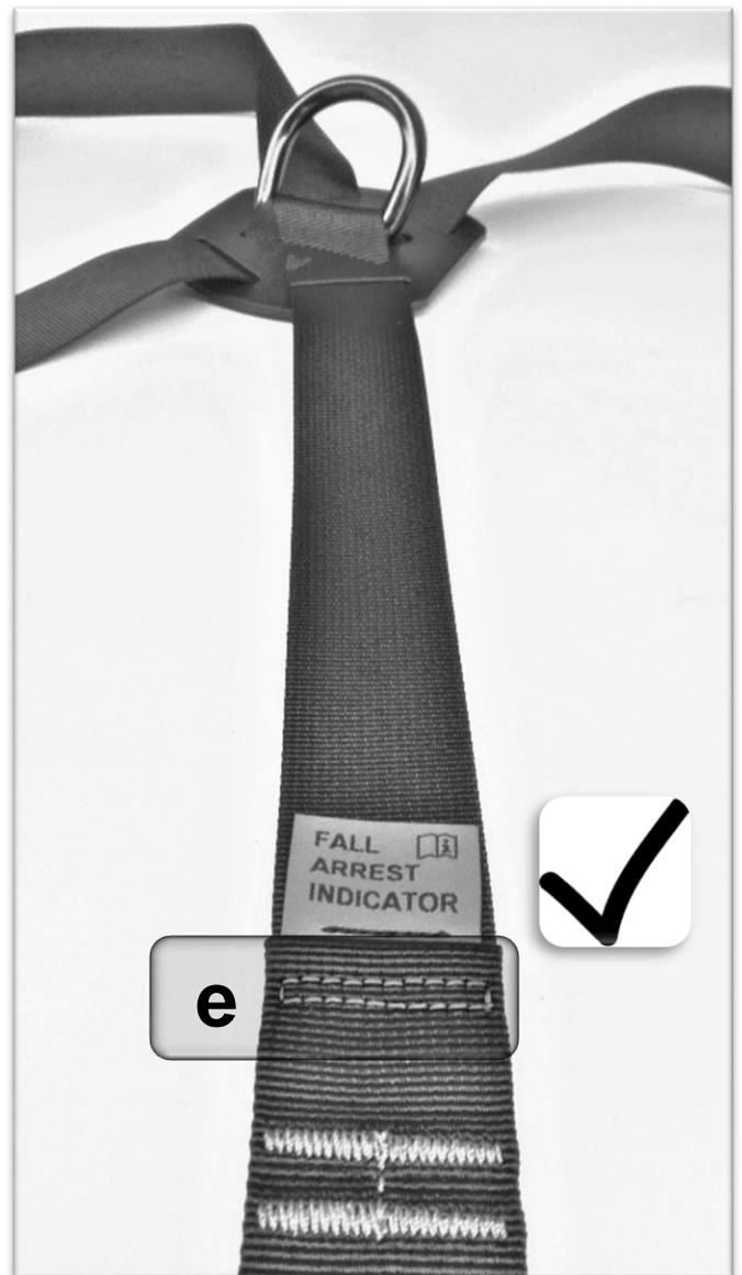
Fallindikator mit Sturzbelastung
